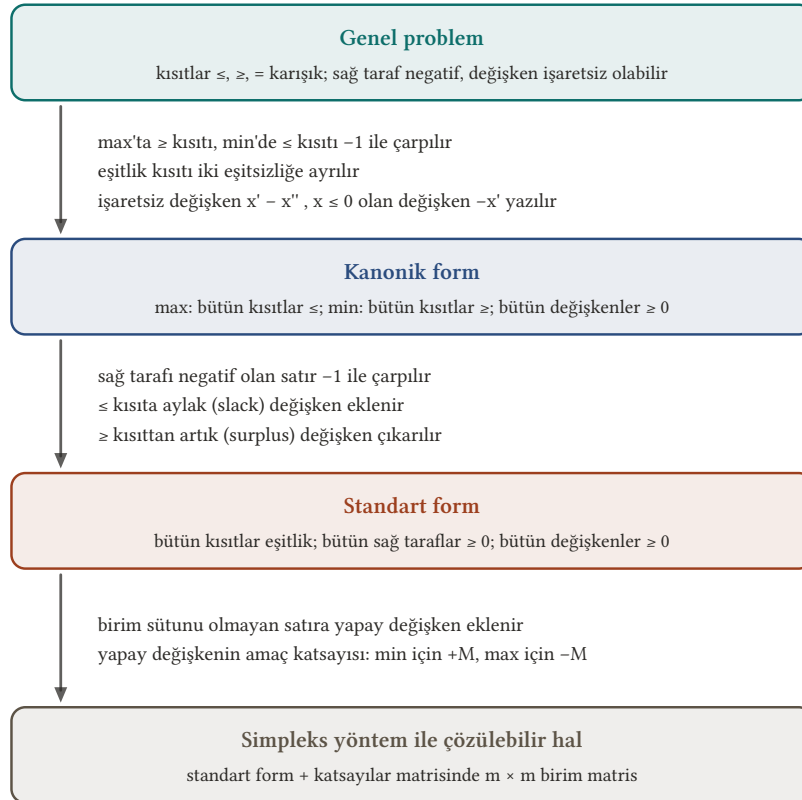
Şekil 1.2: Bir lineer programlama problemini simpleks yöntem ile çözülebilir hale getirme. Okların yanında her geçişte yapılan işlemler yazılıdır.
